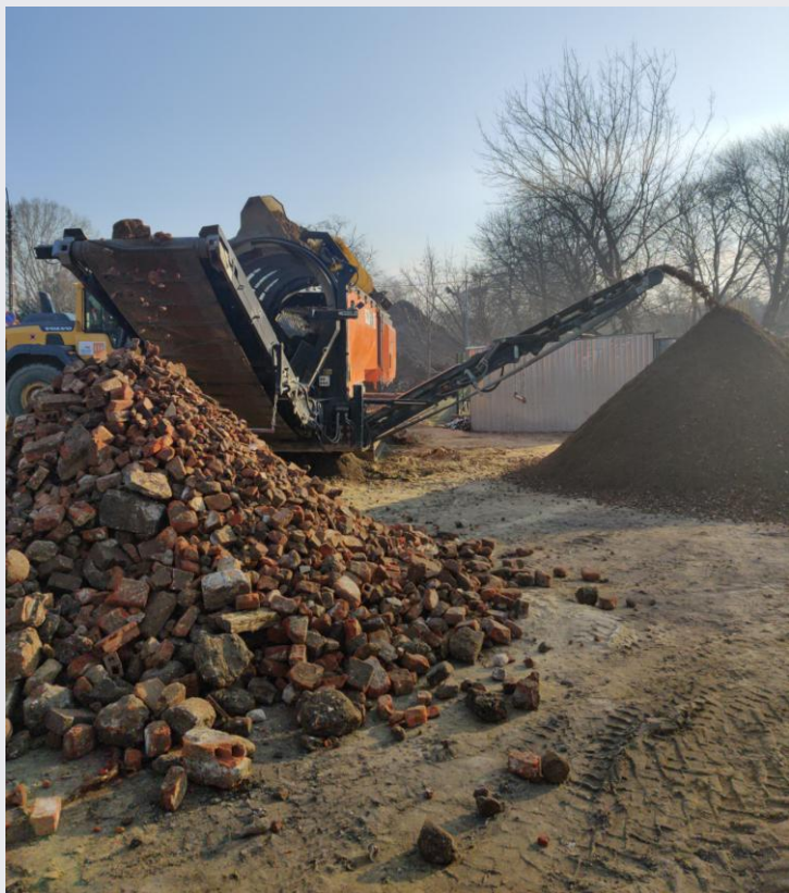
GÓRNICWSTWO MIEJSKIE: SORTOWNIK BĘBNOWO-WALCOWY PODCZAS PRACY NA KOPCU POWSTANIA WARSZAWSKIEGO, 2022 ZDJĘCIE: ARCHIGREST
