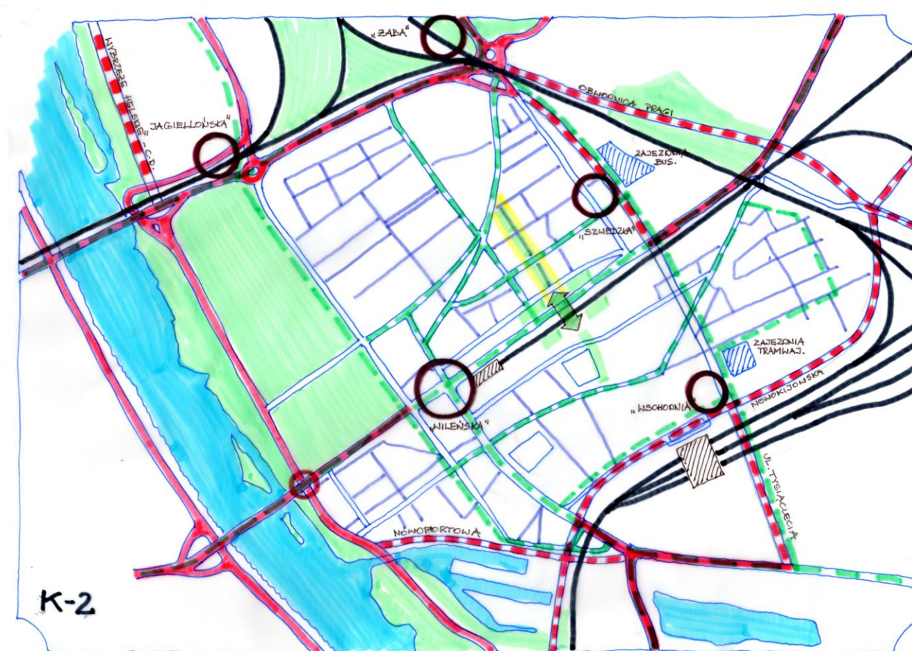
Koncepcja nowego układu komunikacyjnego z zaznaczeniem proponowanych zintegrowanych węzłów przesiadkowych (ZWP) odciążających wnętrze dzielnicy, uwzględniająca skorygowany przebieg linii tramwajowej
